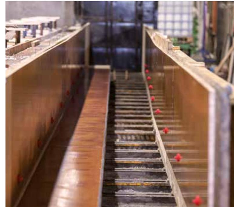
Die Schalung definiert die Form der Fertigteile, in die der Bewehrungskorb eingelassen wird
